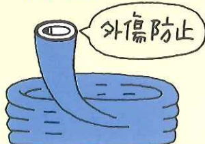
間仕切り基礎貫通の際、管表面に傷が発生しません。
